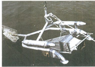
Réceptacle de charriage de fond BFG Coblenze
